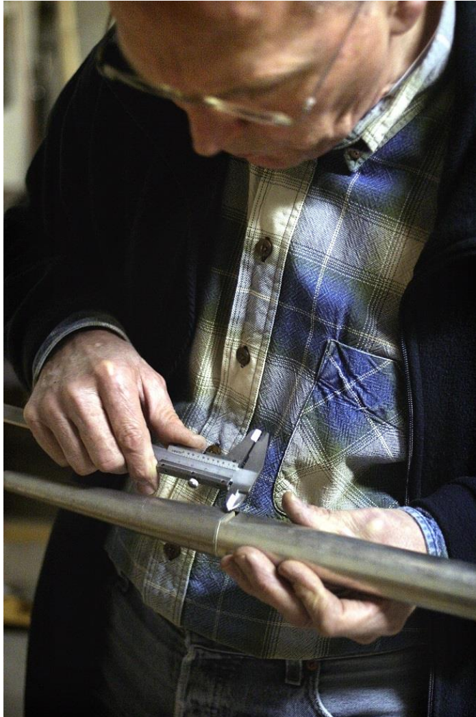
Metten en documenteren van pijpen geeft inzicht in de klank die de oorspronkelijke bouwers van het orgel voor ogen heeft gestaan.
