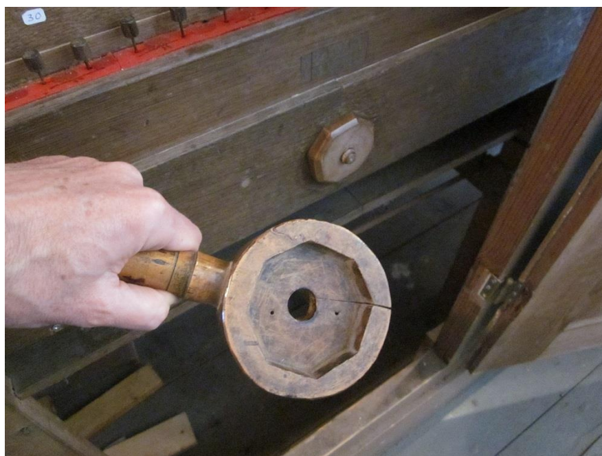
Bij dit orgel bleef een uniek stuk gereedschap bewaard: een palmhouten sleutel voor het los- en vastdraaien van de achthoekige moeren waarmee de voorlagen op hun plaats worden gehouden (Abbekerk).
