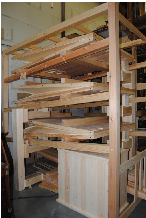
Links: een balgstelling met drie zgn. spaanbalgen. De elektrische ventilator is onderaan in een dempkist geplaatst (Waspik, PKN). Rechts: Een ventilator in een dempkist. Vast moet staan dat de gebruikte materialen, m.n. het dempende kunststof, duurzaam zijn.
